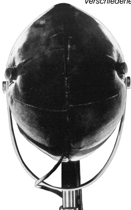
1.a 1954, "Tête Charlin" /6/ mit absorbierendem Material beklebte Kugel mit eingebauten Druckempfängern
