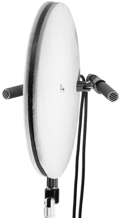
1.d 1980, "OSS", Jecklin-Scheibe /7/ mit absorbierendem Material beklebte Scheibe mit 30cm Durchmesser, mit beidseits im leichten Winkel zueinander angeordneten Druckempfängern
