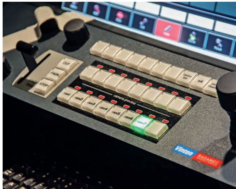
Einstellung um Einstellung: Kamera-Fernsteuersystem Vinten Radamec
