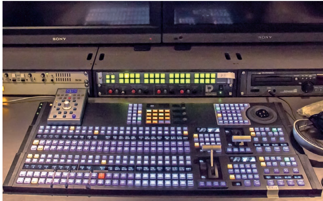
Herzstück der Video-Regie: der SD-/HD-Videomischer SONY MVS-3000
